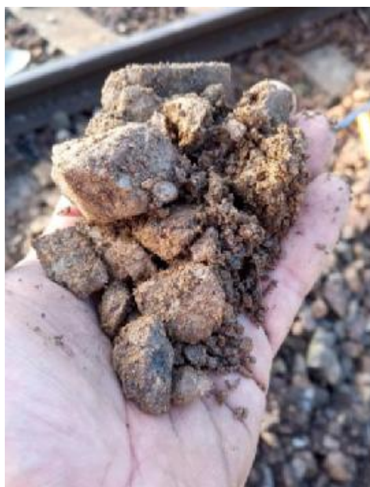
Charakter eluvia skalního podkladu v kopané sondě K1 a detail drobně kusovitě rozpadavé pararuly v kopané sondě K2
