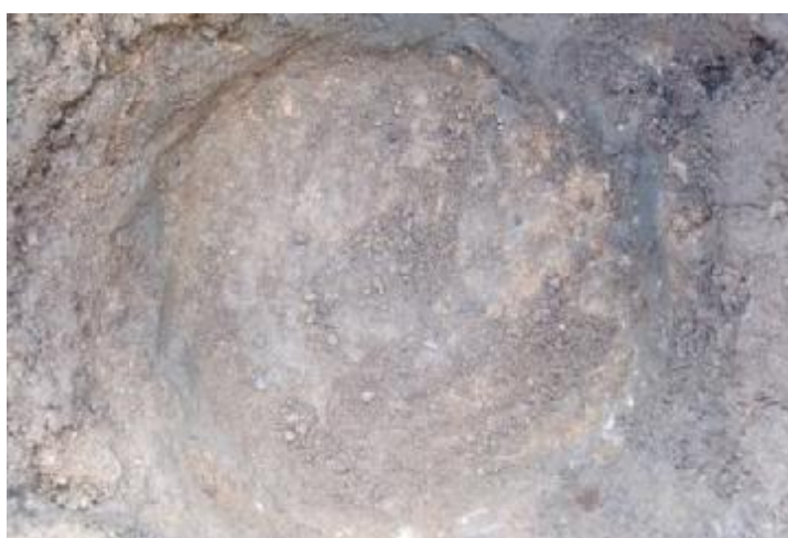
Charakter eluvia skalního podkladu v kopané sondě K1 a detail drobně kusovitě rozpadavé pararuly v kopané sondě K2
